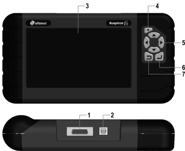
**1 - Conector de Comunicação e Alimentação DB15:** O Cabo OBD Master permite a conexão do scanner com o veículo. É através dele que é feita a alimentação do equipamento na maioria dos casos. No caso de veículos que não possuem alimentação no conector de diagnóstico, a alimentação do equipamento é feita através do cabo adaptador (ver detalhes no tópico 2.2). Abaixo, estão os cabos de alimentação via isqueiro e bateria do tipo jacaré que devem ser conectados junto ao cabo adaptador.
