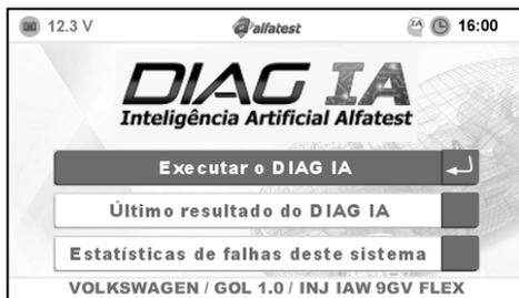
Se a opção escolhida for a de Executar o DIAG IA e o sistema em diagnóstico for da categoria de injeção eletrônica, a tela de condições abaixo será exibida, alertando que o motor deverá estar ligado com uma temperatura de arrefecimento maior ou igual a 80 °C.
