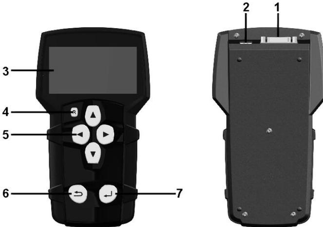
**1 - Conector de Comunicação e Alimentação DB15:** O Cabo OBD Master permite a conexão do scanner com o veículo. É através dele que é feita a energização do equipamento na maioria dos casos. No caso de veículos que não possuem alimentação no conector de diagnóstico, a energização do equipamento é feita através do cabo adaptador (ver detalhes no tópico 2.2). Abaixo, os cabos de alimentação via acendedor de cigarros e bateria do tipo jacaré que devem ser conectados junto ao cabo adaptador.
