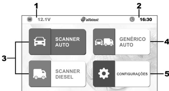
**1 – Indicador de tensão de Bateria:** monitora a tensão da bateria do veículo durante toda a operação. O módulo exibirá o valor da tensão da bateria nas cores verde e vermelho, de acordo com o valor lido e as faixas de trabalho dos veículos:
