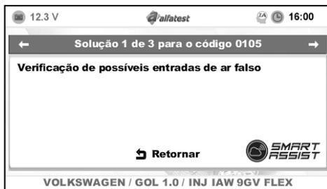
**Modo Falhas:** o scanner apresenta a quantidade de falhas armazenadas na unidade de comando, o status da falha (quando disponível), o código da falha, e a descrição da falha (quando disponível), conforme apresentado abaixo:
